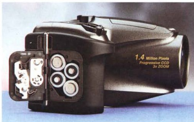
Per l'alimentazione della fotocamera si utilizzano quattro comunissime pile stilo o le "capienti" ricaricabili da 1.3 Ah (!!!) fornite a corredo assieme al caricabatterie.
